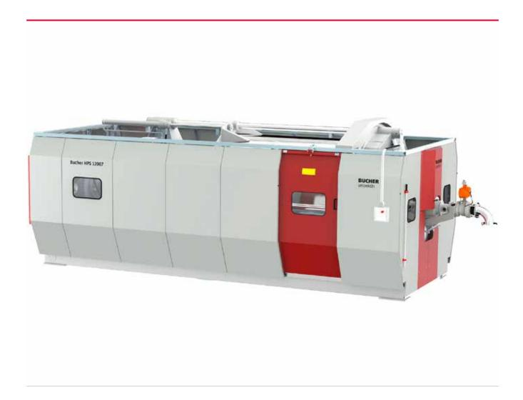
Hydraulische Filterpresse zur Entwässerung von kommunalen und industriellen Schlämmen
