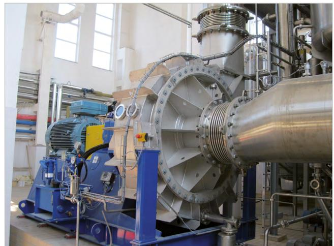
Abb. 5: Ventilatorverdichter in einer Verdampferanlage
