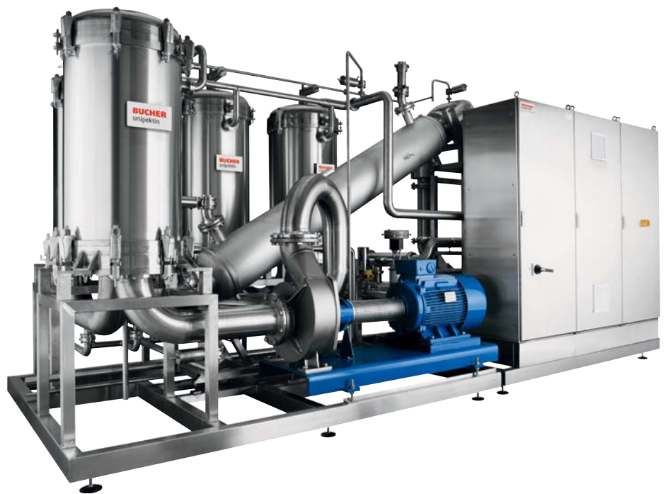
Abb. 1 Auf Skid montierte Cerinox BR
